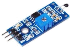
SEN19 1.976 Sensor de Temperatura, especial para medir temperatura por medio de la resistencia.
