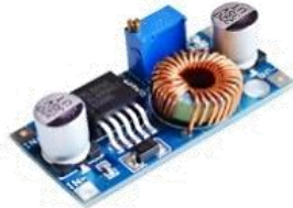
MO42B-2 3.784 XL4005 Modulo regulador de voltaje Entrada: 4-35v Salida: 1.25-32v 5amp
