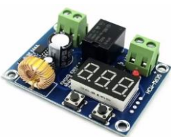
MO44J-1 6.800 XH-M609. Módulo encargado de que la bateria no se descargue por completo. 12V~36V 20amp
