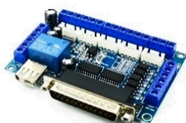
MO18E 28.080 MACH3 Interfaz de 5 ejes, conexión para maquinas CNC.
