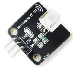
MO24 4.800 KY-005 Modulo infrarrojo, envia comandos a 38Khz
