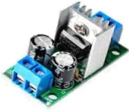
MO25A 4.704 L7805CV Regulador de Voltaje DC, regula el voltaje de 20v hasta 5v
