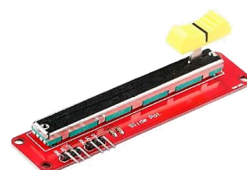
M054A 7.600 Modulo Potenciometro Lineal 10k
