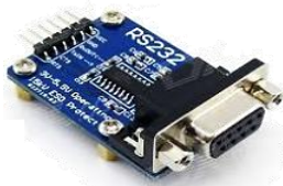
MO07 3.032 RS232 a TTL, convertidor de comunicación de líneas modernas a más antiguas.
