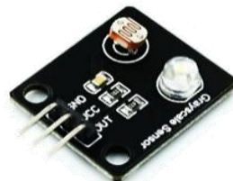
MO06C 1.936 Sensor de luz analogico escala de grises.
