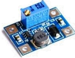
MO42B-1 1.472 SX1308 Elevador de voltaje entrada:2- 24v salida: 28v 1amp
