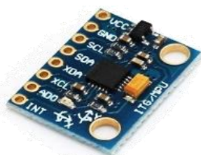
SEN11 7.920 MPU-6500, Sensor de movimiento en 6 ejes - 3 acelerometro y 3 giroscopio
