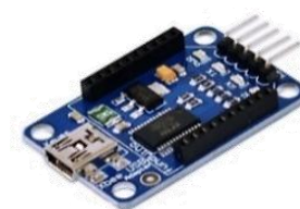
SH13-1 13.680 Xbee Explorer, placa para conectar tus modulos Xbee con una computadora.
