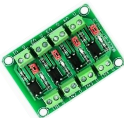
M030-2 Convertidor de voltaje PC817 4 salidas
