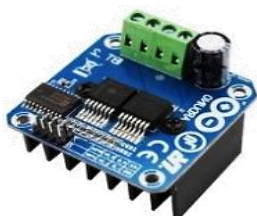
MO18B 17.500 BTS7960 Controlador de motores hasta de 43amp.
