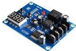
MO44J 8.840 XH-M603 cargador y controlador de carga. Diseñado para automatizar la carga de baterías 12V a 24V
