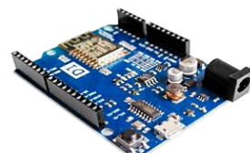
SH05-1 13.448 Placa Wifi D1 - ESP8266, ideal para usar con sensores con un Wi-Fi nativo.
