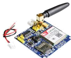
MO04B 23.504 Inalambrico SIM900L, Placa de desarrollo más robusta, que permite a tu arduino conectividad movil.
