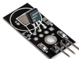
SEN19F 3.056 Sensor de Temperatura LM35DZ, montado en plaqueta par facil intalacion en arduinos.
