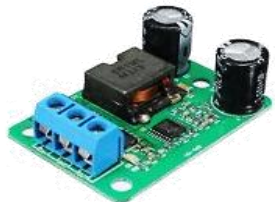
MO42E 12.000 Modulo reductor de corriente Entrada 24-12v Salida 5v 5amp
