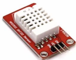
SEN08B DHT22, sensor de temperatura y humedad relativa con capacidades superiores.
