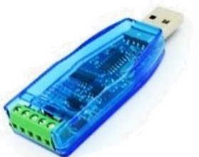
MO08B-1 12.336 RS485 a USB Convertidor donde los picos de voltaje podrían destruir un puerto USB convencional.
