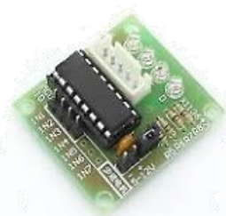
MO17 3.936 ULN2003 Modulo de control para manejar motores paso a paso de pequeña potencia
