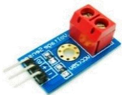
SEN12 1.768 Sensor de Voltaje, Mide voltajes superiores a su limite de entrada en arduinos.
