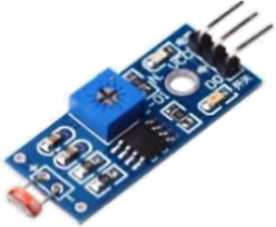
SEN18 1.864 Sensor detector de luz LDR, Detecta la intensidad de la luz ambiental.
