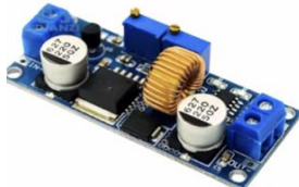
MO44H-1 7.500 Cargador de bateria de litio 5amp corriente DC-DC
