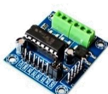
SH01B 4.624 Placa controlador de motores L293D, 2 Motores DC
