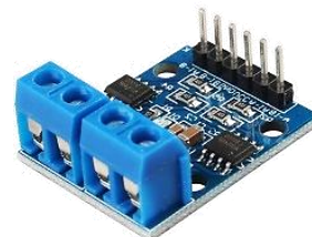
MO27 2.000 Controlador Motores Dual, dos motores DC independientes.
