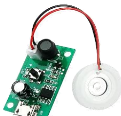
MO76 4.200 Modulo generador de niebla ultrasonico
