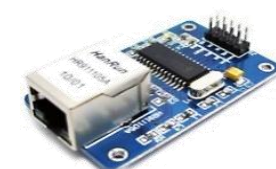
SH06 15.250 Placa Ethernet ENC28J60, placa compacta para realizar conexión ethernet,
