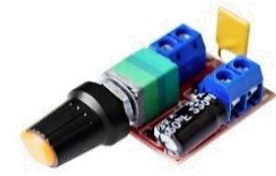
MO19A 3.500 Controlador velocidad Motor DC 5~35v - 10AMP
