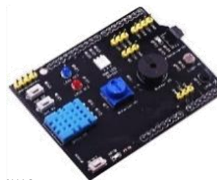
SH16 13.440 Tarjeta expansión que trae, sensor de temperatura, humedad, brillo, IR, buzzer, LDR, potenciómetro, led, pulsadores.
