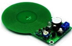
MO63A 4.920 Modulo detector de metales - Desarmado
