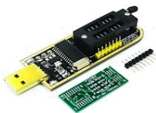
PG5 16.000 Programador USB CH341A serie 25 EEPROM
