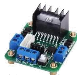
MO18 10.640 L298, controlador de motores, hasta 2 motores DC independientes.
