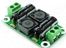
MO42G 5.088 Fuente de poder 0-50v 4amp, Supresor de ruido
