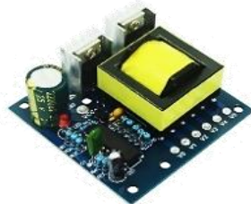
MO42H 20.160 Inversor de Corriente 12v DC a 110v AC 150w
