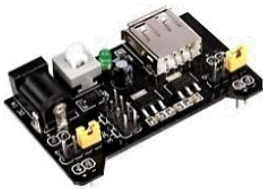
MO41 3.176 Fuente de Alimentación para Protoboard 3.5 - 5v WB102
