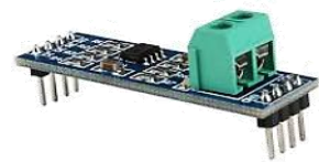
MO09 2.376 RS485 a TTL, módulo convertidor que permite microcontroladores se comuniquen utilizando RS485.
