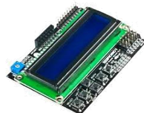
SH03 9.872 Placa LCD con botonera, ideal para actuar directamente en tu arduino sin necesidad de computador.
