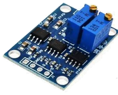
MO74A 13.680 Amplificador de voltaje AD620 6-12v
