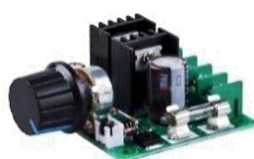
MO19-1 8.400 Controlador velocidad Motor DC 12~40v - 10AMP
