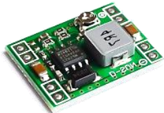
MO41A 2.056 LM2596 Modulo regulador de voltaje Entrada: 3.2-40v Salida: 1.25-35v 2amp
