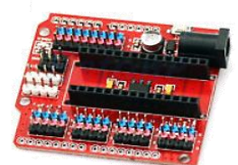
SH07 5.168 Placa expansora para Arduino NANO funcional porque duplica los pines para más conexiones.
