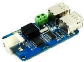
M077A 66.880 Aislador de corriente USB 8 salidas 1500v
