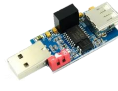
MO77 21.640 Aislador de corriente USB salidas 1500v
