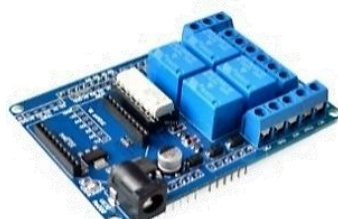
SH15 28.080 Placa de 4 rele mecánicos 70w, Es un controlador de carga de alta potencia que el CHIP no podría manejar.
