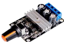
MO19B 4.512 Controlador velocidad Motores PWM DC 6-28v 3amp
