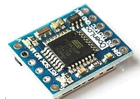
M055 - Registrador de datos Atmega328 con SD
