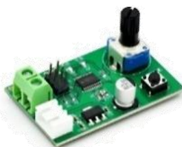
MO19D 11.408 Controlador servomotores SG90, MG995 doble canal
