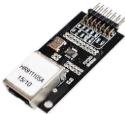
MO08D 10.592 RJ45 a TTL LAN8720 es un transceptor de Ethernet de alto rendimiento y muy bajo consumo.
