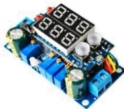
MO40D 64.000 MPPT Controladores paneles solares. Entrada:6-36v Salida: 1,25-32v 5amp
