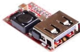
MO45 5.200 Regulador de voltaje Entrada: 12v-24v Salida: 5v 3amp
