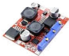
MO47 - LM2577S Regulador de voltaje, mantiene el voltaje de salida independiente que el de entrada cambie.
