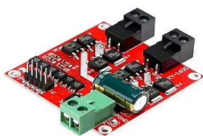
MO18A 27.600 XY-160D L298, Controlador de motores doble puente H mas robusto para corrientes hasta de 7amp
