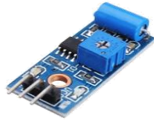
SEN15 1.920 SW420, sensor de vibración de alta sensibilidad.
