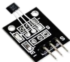
SEN10A - UGN3503, Sensor de efecto Hall montado en placa para facil instalacion en Arduinos.
