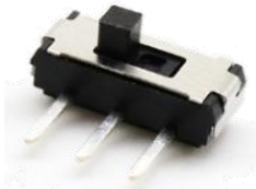
S403 320 Switch lateral 2 posiciones 3 patas
