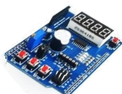
SH12 6.824 Placa de aprendizaje multifunción arduino uno, encaja directamente sobre tu arduino para practicas.
