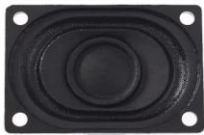
PA100A 4.300 Parlante de dimension 40x28 mm, potencia de 2w, impedancia 8oh
