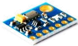
MO12A 20.000 GY-63 un barómetro de alta precisión diseñado para aplicaciones donde la altura es crítica.
