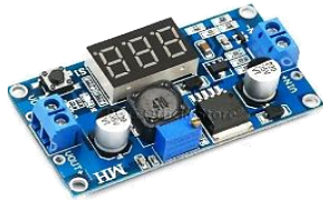
MO42-1 6.000 LM2596 Modulo regulador de voltaje Entrada: 3.2-40v Salida: 1.25-35v 2amp con display
