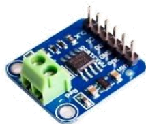
MO68B 31.840 MAX31855K Medidor de temperatura de alta precisión -200°+1350°
