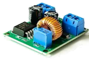
MO47A 9.984 LM2587 Elevador de voltaje Entrada 3v-35v salida 4v-40v 5amp
