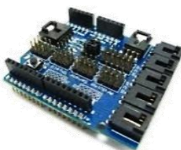
SH04 6.232 Placa expansora para sensores y motores, funcional porque duplica los pines para más conexiones.
