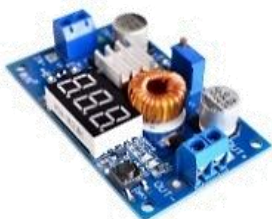
MO48B 75w 8.968 XL4015 reductor de alta potencia entrada: 4-38v dc salida: 1,25v-36v DC 5amp con display.
