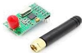
MO04 10.320 NFR905 Transceptor de radio frecuencia de alto rendimiento banda 433Mhz.
