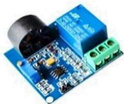
MO61 12.880 Proteccion de sobre corriente 12v - 5amp
