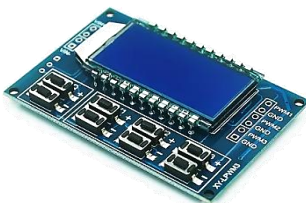
MO67-1 Generador de onda cuadrada 3 canales PWM con display
