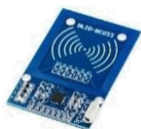
MO36A 6.080 RC522, lector de tarjetas de identificación por radiofrecuencia (RFID)
