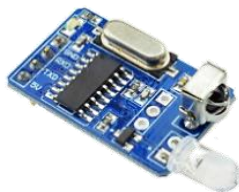
MO06B 11.360 KY-005 - KY-002, Sistema de comunicación infrarroja emisor- receptor.
