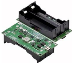
MO44H-4 21.280 Cargador de baterías de litio tipo Boost (Elevador) de alta eficiencia, alimentarse desde una fuente de 5V.
