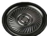
PA101C 600 Parlante de dimension 29 mm, potencia de 0.5w, impedancia 8oh
