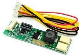
MO40E - Modulo LED inverter, reemplazo circuitos de retroiluminacion pantallas led
