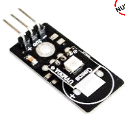
SEN18B 35.832 UVM-30A, Sensor especializado en medir la intensidad de radiación Ultravioleta UV
