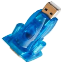
MO08C 5.000 USB a DB9, Diseñado para computadoras que no cuentan con puerto serial DB9.
