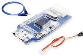
PG7 58.000 Programador de simulación Compatible j-link OB ARM, SWD, STM32
