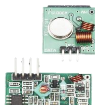
MO05 3.056 Radio Frecuencia 315Mhz, para comunicación inalámbrica unidireccional.
