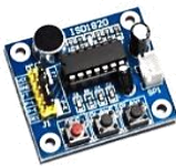
MO21 6.704 ISD1820 Módulo de grabación y reproducción de voz que permite almacenar un mensaje de audio (hasta 10 segundos) y reproducirlo.
