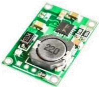
MO11B 2.1 amp 3.528 TP5100 Cargador de baterias de alto rendimiento, más eficiente al manejar corrientes altas 4.2 o 8.4V.
