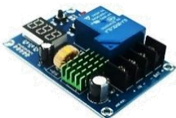
MO44G 11.752 XH-M604 controlador de carga universal capaz de gestionar baterías desde 6V hasta 60V.
