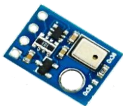
SEN08E 6.400 AHT10, sensor de temperatura y humedad avanzado, compacto y muy preciso.
