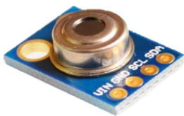
SEN19G 29.224 MLX90614, Sensor de Temperatura a distancia, sin contacto.
