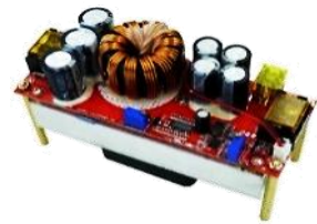
MO40-3 1800w 64.000 Elevador de Voltaje de 1800w, entrada 10-60v salida 12-90v 20amp
