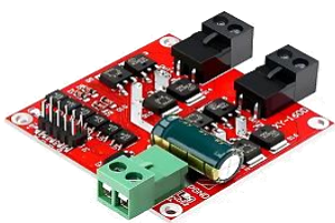
MO18A 35.000 XY-160D L298, Controlador de motores doble puente H mas robusto para corrientes hasta de 7amp
