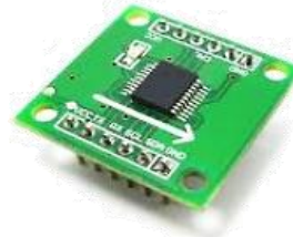
MO12 13.440 GY-26 Módulo de brújula electrónica diseñado para la navegación de robots y sistemas de posicionamiento.
