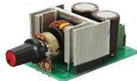
MO19 6.000 Controlador de velocidad motores AC 110v - 220v
