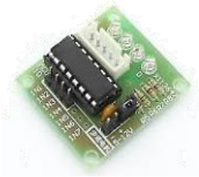
MO17 6.000 ULN2003 Modulo de control para manejar motores paso a paso de pequeña potencia
