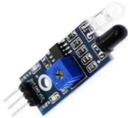
MO03 Modulo detector de objetos de frente distancias largas. Evasor de obstaculos
