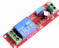
MO69F 4.500 NE555 Temporizador con switche - Timer 0~10S, apagado automatico
