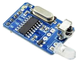
MO06B 11.360 KY-005 - KY-002, Sistema de comunicación infrarroja emisor- receptor.
