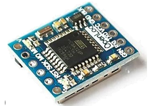
MO55 - Registrador de datos Atmega328 con SD
