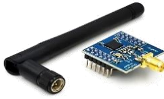
RAS3-3 23.530 Raspberry Zigbee TI 2530 placa de desarrollo
