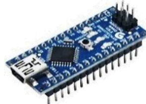
AR1002A 17.500 Arduino NANO, ATmage328P
