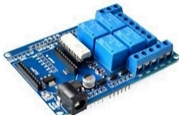
SH15 28.080 Placa de 4 relés mecánicos 70w, Es un controlador de carga de alta potencia que el CHIP no podría manejar.
