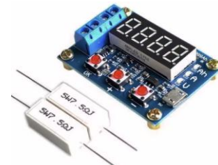
MO44K 9.600 ZB2L3 Probador capacidad baterías (analizador de descarga) mide los Amperios-hora reales de una celda.
