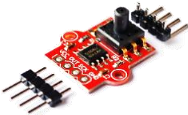
M12B 8.000 Sensor para medir presión de aire o nivel de agua
