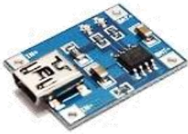
MO11 1 amp 1.200 TP4056 Cargador de Baterias, carga y proteger baterías de litio (Li-Ion o LIPo) de 3.7V
