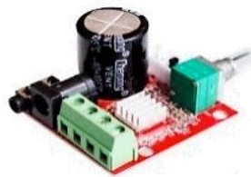
MO16A 20w 9.500 PAM8616 amplificador de audio stereo 2x10W
