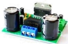
MO16C 100w 30.000 TDA7293 amplificador de audio stereo 2x50W
