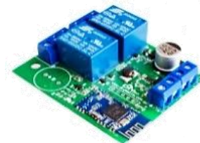
MO69D 60.000 Interruptor Dual wifi, Placa de dos switches con conectividad Wifi
