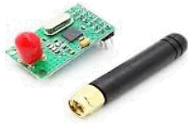
MO04 13.760 NFR905 Transceptor de radio frecuencia de alto rendimiento banda 433Mhz.
