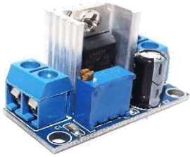
MO25 4.560 LM317T Regulador de Voltaje DC, regula el voltaje de 40v hasta 1,5v
