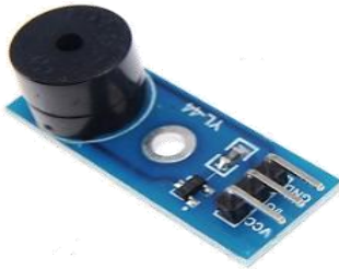
MO20 2.280 Zumbadores (buzzers) son los dispositivos más sencillos para añadir alertas sonoras a tu proyecto.
