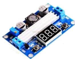
MO42F 17.800 LTC1871 Elevador de voltaje Entrada: 3v-35v Salida 3,5-35v 9amp
