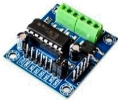
SH01B 8.000 Placa controlador de motores L293D, 2 Motores DC
