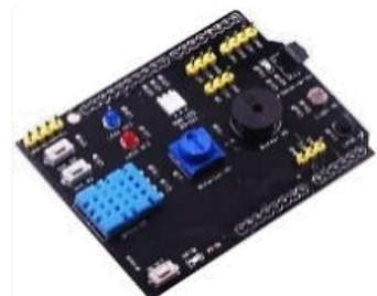
SH16 17.000 Tarjeta expansión que trae, sensor de temperatura, humedad, brillo, IR, buzzer, LDR, potenciómetro, led, pulsadores.
