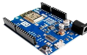
SH05-1 17.000 Placa Wifi D1 - ESP8266, ideal para usar con sensores con un Wi-Fi nativo.
