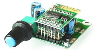
MO16B 30w - Amplificador Audio stereo 2x15W 12 o 24v con Bluetooth
