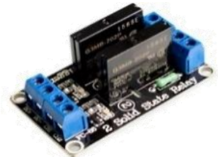
MP34A 12.000 Relevo Sólido 2 Canales 2a - 250v
