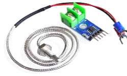
SEN19B 17.500 MAX6675, Sensor de Temperatura 0 a 800° - MAX6676 con termocupla
