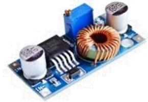
MO42B-2 5.840 XL4005 Modulo regulador de voltaje Entrada: 4-35v Salida: 1.25-32v 5amp
