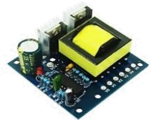
MO42H 25.000 Inversor de Corriente 12v DC a 110v AC 150w
