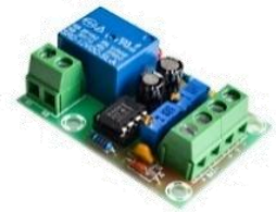
MO44B 7.000 XH-M601 Módulo de control de carga diseñado para automatizar Encendido y Apagado inteligente.
