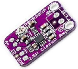
MO15C 2.5w 400 PAM8302 amplificador de audio baja potencia monofonico 2.5W
