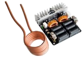
MO72 178.200 Calentador por induccion 20amp 1000w
