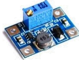
MO42B-1 2.800 SX1308 Elevador de voltaje entrada:2-24v salida: 28v 1amp
