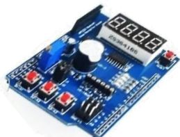
SH12 9.000 Placa de aprendizaje multifunción arduino uno, encaja directamente sobre tu arduino para practicas.
