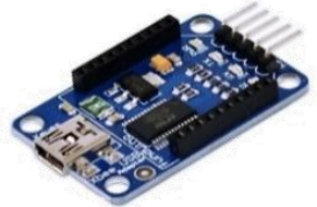
SH13-1 13.680 Xbee Explorer, placa para conectar tus modulos Xbee con una computadora.
