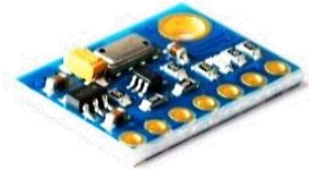
MO12A 29.600 GY-63 un barómetro de alta precisión diseñado para aplicaciones donde la altitud es crítica.
