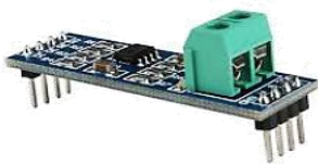
MO09 2.800 RS485 a TTL, módulo convertidor que permite microcontroladores se comuniquen utilizando RS485.
