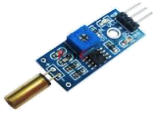
SEN14 2.800 SW460D, sensor de vibración e inclinación tipo mecanico
