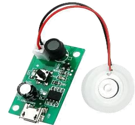
MO76 6.000 Modulo generador de niebla ultrasonico
