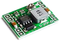
MO41A 2.800 LM2596 Modulo regulador de voltaje Entrada: 3.2-40v Salida: 1.25-35v 2amp
