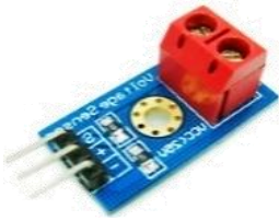
SEN12 2.500 Sensor de Voltaje, Mide voltajes superiores a su limite de entrada en arduinos.
