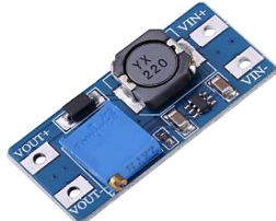
MO42B 2.600 MT3608 Elevador de voltaje entrada:2-24v salida: 28v 1amp
