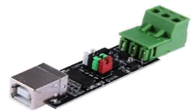
MO08A 9.500 USB 2.0 a TTL RS485, Permite que tu computadora se comunique con dos tipos de dispositivos diferentes.
