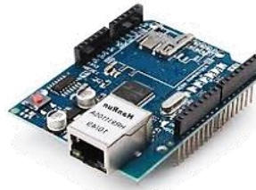
SH02 Placa ethernet W5100, util para conectar tu arduino a internet por medio de conector RJ45
