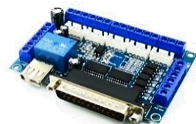
MO18E 28.080 MACH3 Interfaz de 5 ejes, conexión para maquinas CNC.
