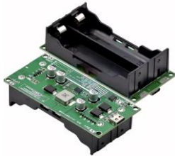
MO44H-4 21.280 Cargador de baterías de litio tipo Boost (Elevador) de alta eficiencia, alimentarse desde una fuente de 5V.
