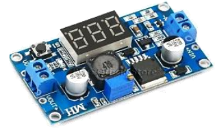
MO42-1 - LM2596 Modulo regulador de voltaje Entrada: 3.2-40v Salida: 1.25-35v 2amp con display
