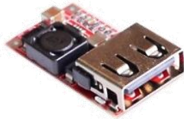
MO45 - Regulador de voltaje Entrada: 12v-24v Salida: 5v 3amp
