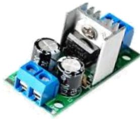
MO25A 6.000 L7805CV Regulador de Voltaje DC, regula el voltaje de 20v hasta 5v
