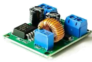
MO47A 12.160 LM2587 Elevador de voltaje Entrada 3v-35v salida 4v-40v 5amp
