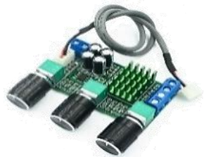
MO16H 16.000 Amplificador 2 x 80w DC - 12/24v TPA3116D2
