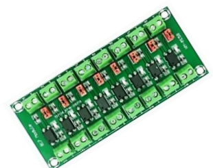
MO30-3 12.000 Convertidor de voltaje PC817 8 salidas
