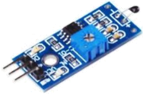
SEN19 2.450 Sensor de Temperatura, especial para medir temperatura por medio de la resistencia.
