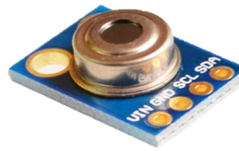
SEN19G 39.200 MLX90614, Sensor de Temperatura a distancia, sin contacto.
