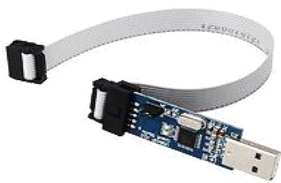
PG1 - Programador USB a ISP para Atmel
