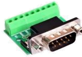
MO07A-1 4.000 RS232 a Conector, convertidor de comunicación, RS232 Macho a conector.
