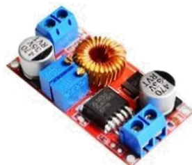
MO40C 7.000 XL4015 reductor de alta potencia entrada: 4-38v dc salida: 1,25v-36v DC 5amp.
