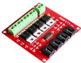
MO31B 15.920 Mosfet de 4 Canales IRF540
