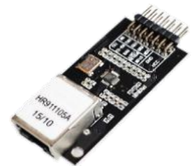
MO08D 15.200 RJ45 a TTL LAN8720 es un transceptor de Ethernet de alto rendimiento y muy bajo consumo.
