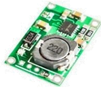
MO11B 2.1 amp 4.000 TP5100 Cargador de baterias de alto rendimiento, más eficiente al manejar corrientes altas 4.2 o 8.4V.
