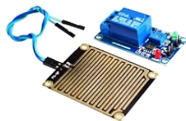
MO69E 9.800 Sensor de lluvia con interruptor, Con este modulo cuando detecta agua activa o desactiva dispositivos
