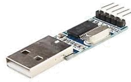
MO08 5.280 PL2303 convertidor USB, diseñado para permitir que una comunicación con dispositivos que usan lógica TTL
