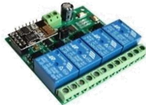
MO69-1 50.400 Modulo de 4 canales con wifi para aplicaciones movil
