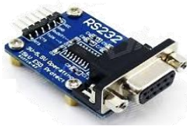
MO07 3.800 RS232 a TTL, convertidor de comunicación de líneas modernas a más antiguas.
