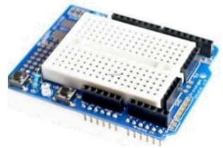
SH10 6.500 Placa Protoboard 170 puntos para arduino, perfecta para proyectos compactos
