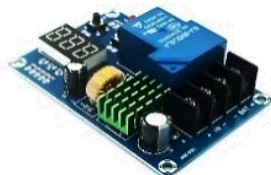
MO44G 15.000 XH-M604 controlador de carga universal capaz de gestionar baterías desde 6V hasta 60V.
