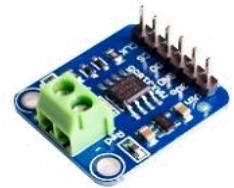
MO68B 31.840 MAX31855K Medidor de temperatura de alta precisión -200°+1350°
