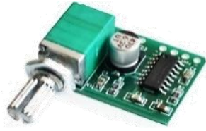
MO15A 5w 3.500 PAM8403 amplificador de audio monofonico 5W
