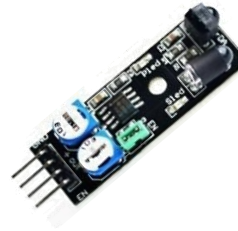
MO03B-1 4.480 KY-032 Modulo detector de objetos de frente distancias largas. Es más robusto frente a la luz ambiental.
