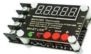
MO68A 76.000 Modulo colector de temperatura de alta precision MAX31865
