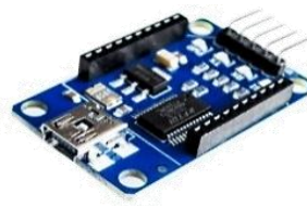
SH13 17.000 Xbee Zigbee Bluetooth HC5, placa especial para conectarse desde tu arduino con modulos Xbee.
