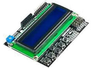
SH03 12.000 Placa LCD con botonera, ideal para actuar directamente en tu arduino sin necesidad de computador.
