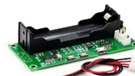
MO16M 16.000 Amplificador de audio con pila de litio 6w PAM8403
