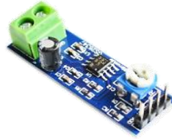
MO15B 1w 3.500 LM386 amplificador de audio baja potencia monofonico 1W
