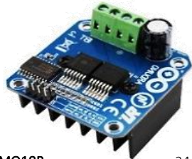
MO18B 24.320 BTS7960 Controlador de motores hasta de 43amp.
