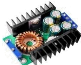
MO40-1 150w 10.000 Regulador de voltaje de 150w, entrada 5-40v salida 1,2-35v 6amp
