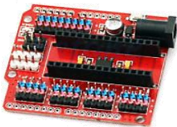
SH07 6.400 Placa expansora para Arduino NANO funcional porque duplica los pines para más conexiones.
