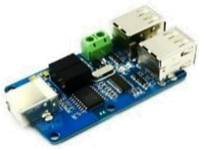
MO77A 66.880 Aislador de corriente USB 8 salidas 1500v
