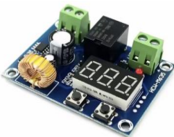
MO44J-1 10.000 XH-M609. Módulo encargado de que la bateria no se descargue por completo. 12V~36V 20amp
