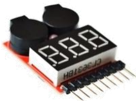
MO46 7.200 Provador de voltaje y aviso carga baja (buzzer)
