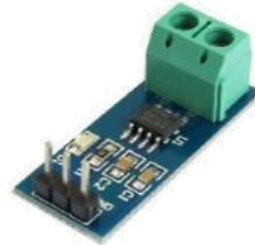
SEN13-30 30amp 7.000 ACS712, sensor de corriente AC/DC - 30amp
