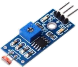
SEN18 2.300 Sensor detector de luz LDR, Detecta la intensidad de la luz ambiental.
