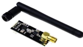
MO04D 13.180 NRF24L01+ módulo de radiofrecuencia 2.4 GHz donde necesitas que dos Arduinos se hablen sin cables.
