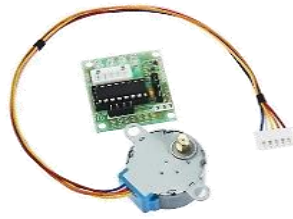
MO17A 8.000 ULN2003 Modulo de control para manejar motores paso a paso + Motor paso a paso
