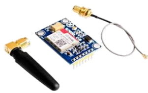
MO04A 23.000 Inalambrico SIM800L, Modulo que permite a tu arduino a enviar SMS, Voz, Internet.
