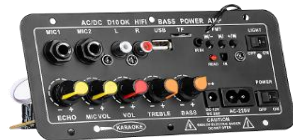
AM2701 73.000 Tarjeta amplificadora para cabina de sonido con potencia de 300w, con control remoto
