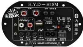
AM2700 54.000 Tarjeta amplificadora para cabina de sonido con potencia de 250w, con control remoto
