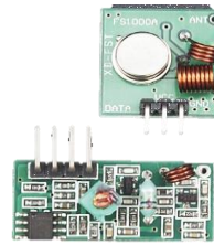
MO05 4.000 Radio Frecuencia 315Mhz, para comunicación inalámbrica unidireccional.
