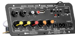
AM2702 110.000 Tarjeta amplificadora para cabina de sonido con potencia de 600w, con control remoto
