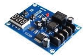
MO44J 11.200 XH-M603 cargador y controlador de carga. Diseñado para automatizar la carga de baterías 12V a 24V
