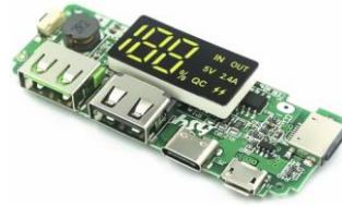
MO441 9.000 Cargador de baterías, tambien gestiona la salida de energía hacia tus dispositivos, todo con una pantalla LCD.
