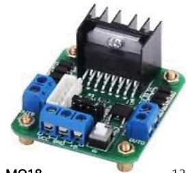
MO18 13.000 L298, controlador de motores, hasta 2 motores DC independientes.
