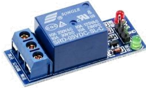
MO29-1 - Modulo relevo de 1 canal 12V
